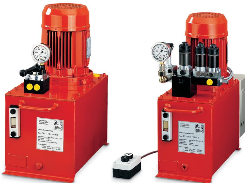
Die Hydraulikaggregate der Modelle PY verfügen über zweistufige Pumpen, d.h. eine Niederdruckstufe füllt den Hydraulikzylinder zügig bis der Druck auf 80 bar ansteigt. Die Hochdruckstufe schaltet sich automatisch (bis 700 bar) zu, während die Niederdruckstufe zum Tank entlastet wird. Diese kostengünstige Lösung verhindert eine zu große Erwärmung, spart Energie und hält die Aggregate kompakt.
